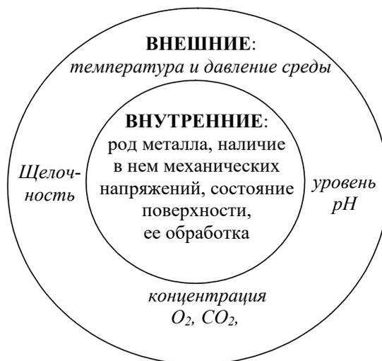
Рис. 1.9. Факторы, влияющие на интенсивность коррозии
